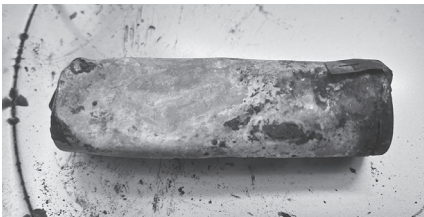
ペットボトルのリサイクル処理中、発火した乾電池
